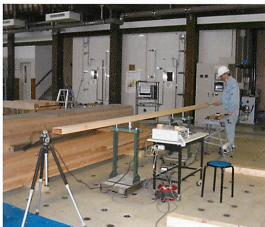
写真2 縦振動ヤング率の測定
